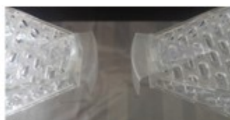
Vue de détail des Brise-vue de réducteur. Ils sont découpés dans des barquettes alimentaires rondes destinées aux plats préparés de 125mm.
